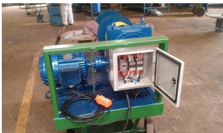
ANEXO 8 - Teste de içamento de 925kg com o guicho eletromecânico.
